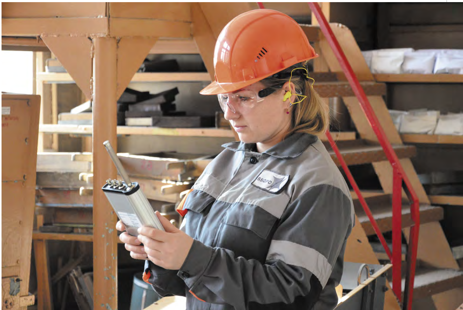
ОПЕРАТОР АКУСТИЧЕСКИХ ИСПЫТАНИЙ ПРОИЗВОДИТ ЗАМЕР ШУМА В ПРОБОРАЗДЕЛКЕ ОТК «ССГПО»
