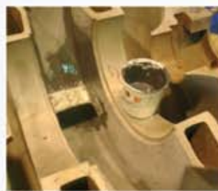
Рис. 3 Покрытие насоса Loctite® 7227
