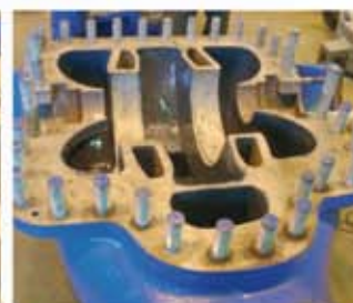
Рис. 4 Полное покрытие поверхности, после частичного отверждения наносится второй слой
