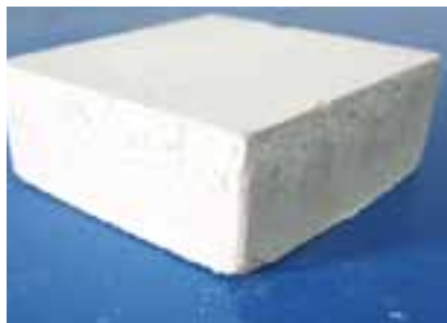
ОБРАЗЕЦ ПОЛУЧЕННЫЙ ПРИ ПОЛУСУХОМ ПРЕССОВАНИИ И КАРБОНИЗАЦИИ ШЛАКОВ РАФИНИРОВАННОГО ФЕРРОХРОМА
