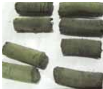
ОБРАЗЦЫ БРЭКСОВ, ПОЛУЧЕННЫХ МЕТОДОМ ЖЕСТКОЙ ЭКСТРУЗИИ
