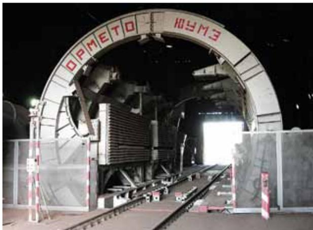
российского концерна ОРМЕТО-ЮУМЗ. Мощный агрегат предназначен для выгрузки сыпучих материалов (в данном конкретном случае угля) в приемные бункеры ЦОФ «Восточная».
