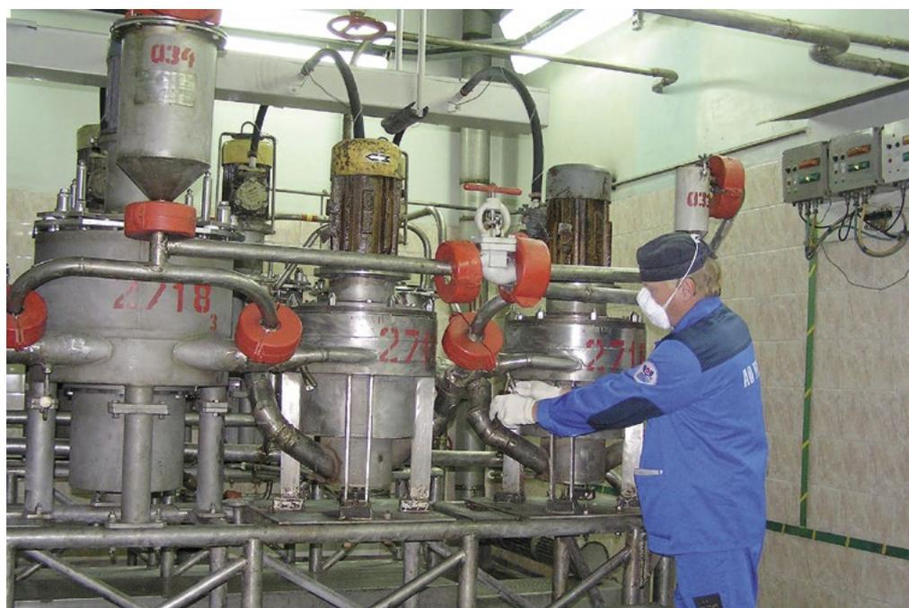
создана технологическая схема с замкнутым циклом рециркуляции растворов, предназначенных для очистки отходящих газов.
