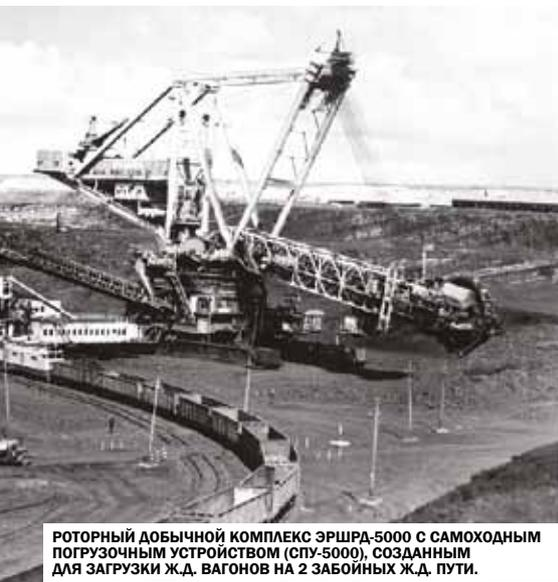
РОТОРНЫЙ ДОБЫЧНЫЙ КОМПЛЕКС ЭРШРД-5000 С САМОХОДНЫМ ПОГРУЗОЧНЫМ УСТРОЙСТВОМ (СПУ-5000), СОЗДАННЫМ ДЛЯ ЗАГРУЗКИ Ж.Д. ВАГОНОВ НА 2 ЗАБОЙНЫХ Ж.Д. ПУТИ.
