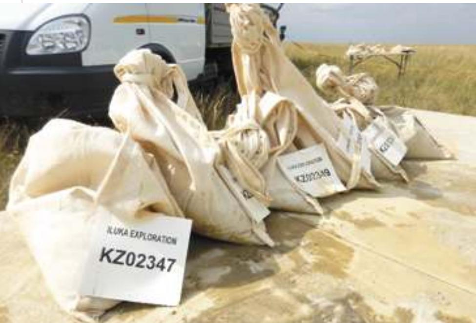
и на поверхности геологи получают уже готовый образец. Его помещают сначала в специальный холщовый мешок, а после в пластиковый контейнер с необходимой маркировкой. Специалисты отмечают, что данная технология позволяет получать образцы даже жидкоподвижного песка.
