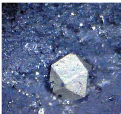
Рисунок 3. Отдельный кристалл пирита на поверхности угля месторождения Кулан
