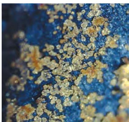
Рисунок 2. Включения на поверхности угля месторождения Шоптыколь (сростки отдельных включений)
