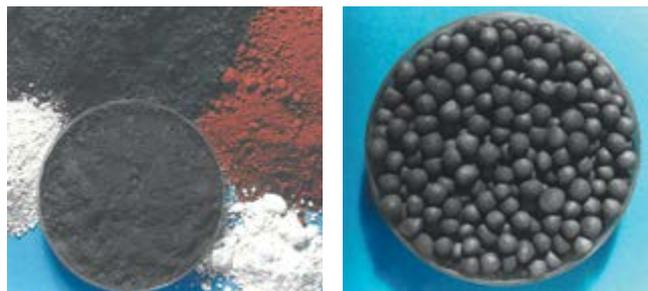
Процесс, известный теперь как вельц-процесс, в настоящее время используется последние 50 лет для восстановления цинка из побочных продуктов, например, пыль сталелитейных комбинатов. Для этой цели необходимо переработать пыль с помощью углеродного носителя с образованием стабильных гранул. Для этой цели используются всемирно известные гранулирующие смесители EIRICH.
