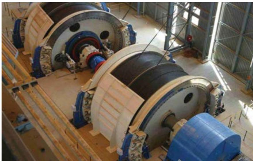
Двухбарабанная подъемная машина системы Блеер (Blair) была изготовлена SIEMAG TECBERG для South Deep Cold Mines (Вестонария/ЮАР) и является одной из самых больших подъемных машин в мире. Технические данные: мощность привода – 13.000 кВт; диаметр барабана – 7,1 метр; высота подъема – 3000 метров.
