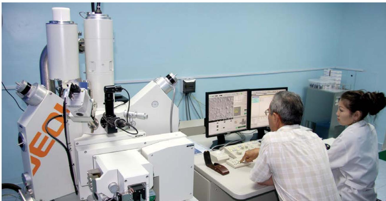
ИССЛЕДОВАНИЯ НА МИКРОЗОНДОВОМ АНАЛИЗАТОРЕ
