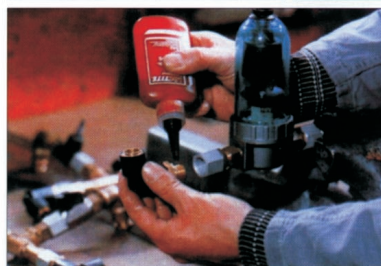
Анаэробный клей применяют простейшим способом: прямо из тюбика наносят на резьбу закручиваемой детали.
