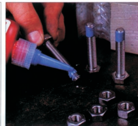
Анаэробный клей применяют простейшим способом: прямо из тюбика наносят на резьбу закручиваемой детали.
