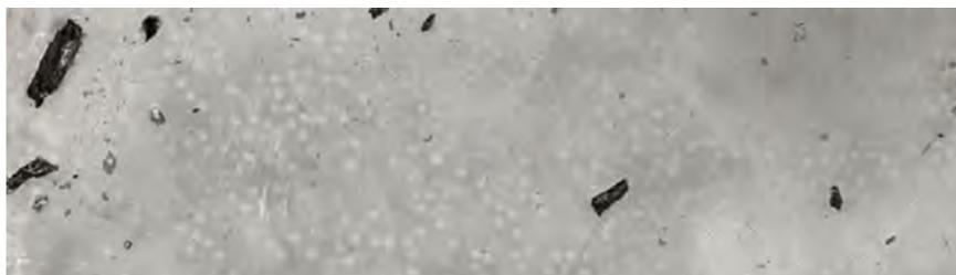
Композитный пенометалл — это своего рода смесь из двух металлов разного типа. Например, соединение стали с алюминием. Принцип его изготовления заключается в пропускании через расплавленный металл горячего газа. Затем полученный таким образом сплав заливают в форму со стальными, титановыми или керамическими полыми шариками. Созданный материал, помимо высокой прочности,
