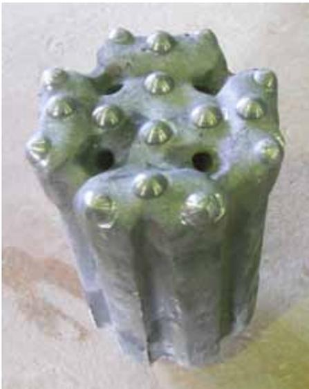
РИСУНОК №3 И №4: ГИДРОПЕРФОРАТОРНАЯ КОРОНКА КНШ-127.T60.ARS ПРОИЗВОДСТВА ЗАО «МХ» В УСЛОВИЯХ ООО «СЕВЕРСТАЛЬ-ЗОЛОТО».
