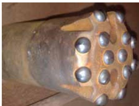
РИСУНОК № 6 ГИДРОПЕРФОРАТОРНАЯ КОРОНКА КНШ-89.ST58.BS ПРОИЗВОДСТВА ЗАО «МХ» В УСЛОВИЯХ ЗАО «ЗЖРК».
