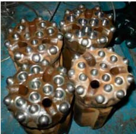
РИСУНОК №7 ГИДРОПЕРФОРАТОРНЫЕ КОРОНКИ КНШ-89.T51.11.ARSr ПРОИЗВОДСТВА ЗАО «МХ», В ОАО «УЧАЛИНСКИЙ ГОК».
