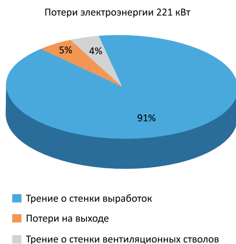
Рис. 3. Диаграмма потерь давления воздуха существующей системы вентиляции
