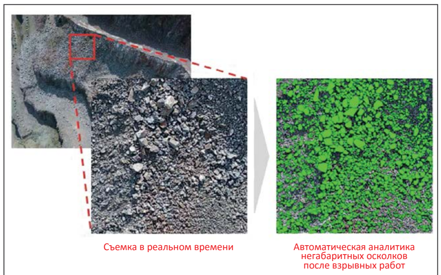
Рис. 2. Анализ взрывных работ и оценка негабаритных осколков на основе цифровых фотографий
